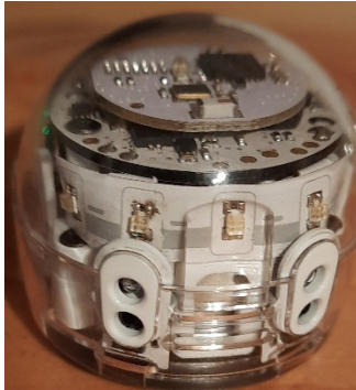
Abbildung 4: Ozobot evo mit Abstandssensoren an der Rückseite
